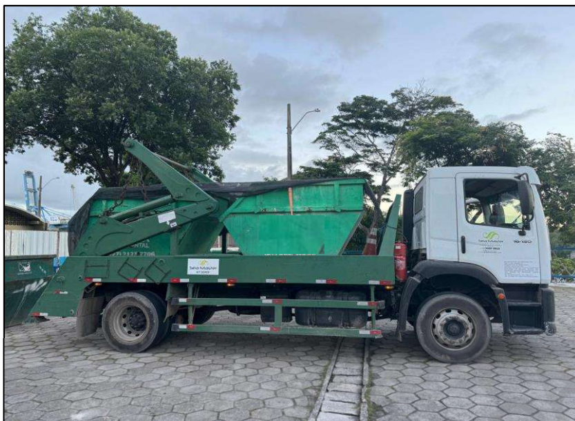
Figura 31: Coleta e transporte dos resíduos sendo realizada com caçambas cobertas
