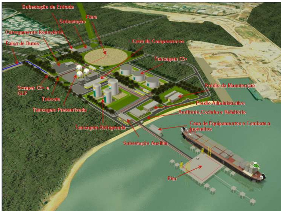
Figura 1: Localização das diversas instalações do Terminal de Barra do Riacho
